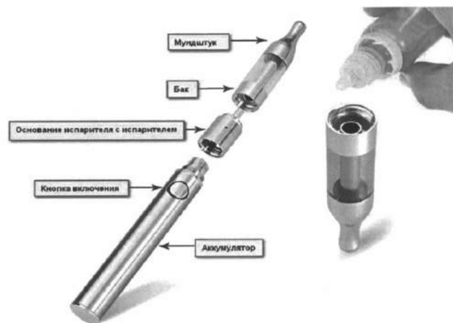
Рис. 3. Устройство электронной сигареты
